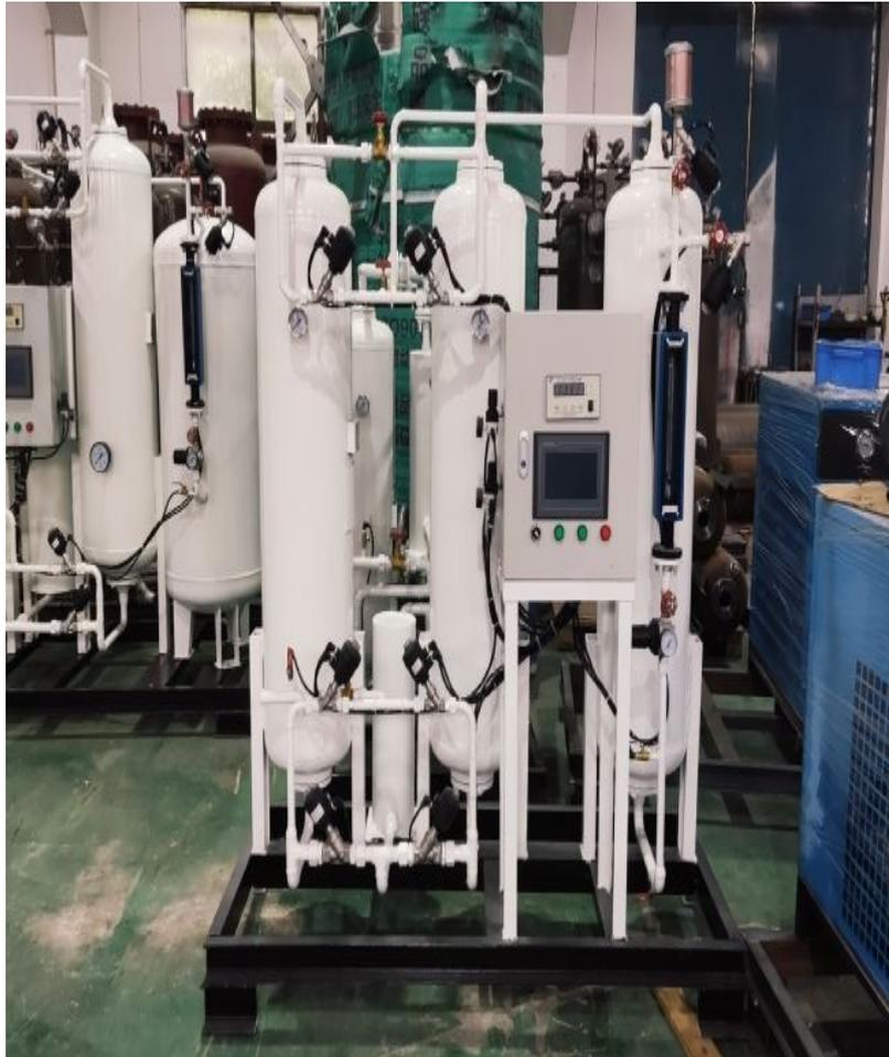
制氮机被广泛用于各行各业，从压缩空气储罐中提供稳定的 99.5%纯度的商业无氧氮气。对于任何工业过程来说，制氮机被认为比氮气瓶更适合，因为现场设备更加紧凑、可靠、易于使用和安装。然而，使用这些发生器并不是没有任何风险的。
