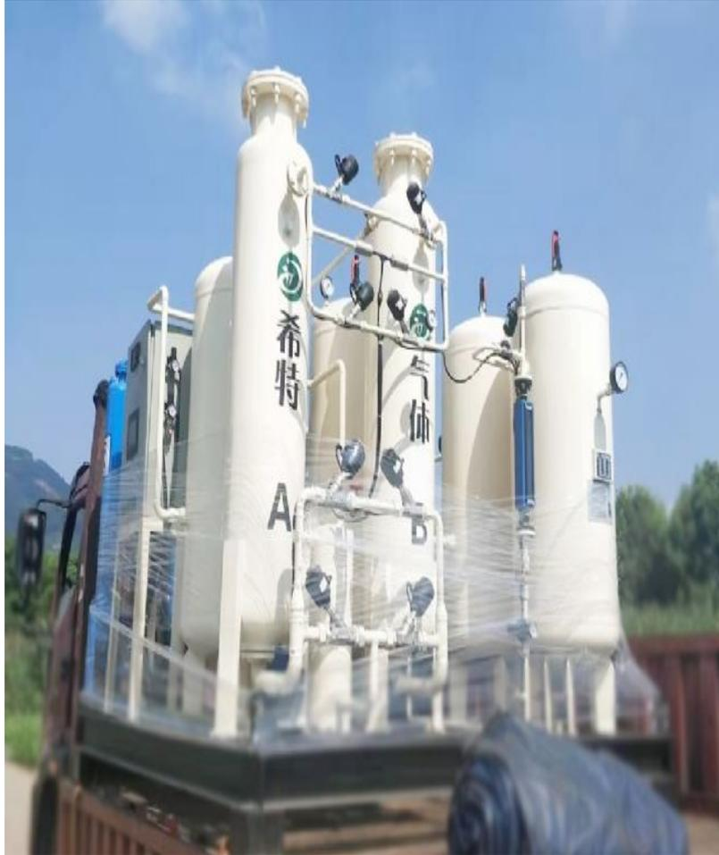
气体生成, 氮气, PSA 制氮机
