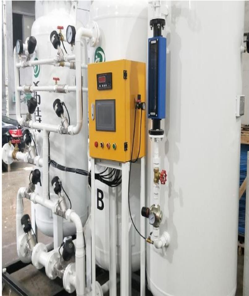
PSA 制氮机，氮气设备，氮气
