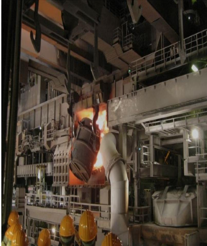
在碱性氧气炉（BOF）的炼钢过程中，氧气（O<sub>2</sub>）被吹入混合料中，由于转炉容器中发生的化学反应，大量高温且富含一氧化碳（CO）的气体从转炉口流出。在这个阶段，气体是非常热的（温度为 950 摄氏度或更高），并带有灰尘。这种气体被称为 LD 气体、BOF 气体或转炉气体。就热值和沃贝指数而言，转炉煤气通常被归类为贫气，但就其燃烧特性（尤其是燃烧温度）而言，则属于富气范畴。
